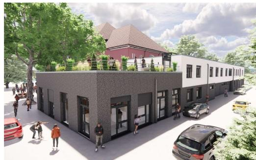
Dies bietet viele Vorteile gegenüber einem konventionellen Dach, wie z.B. die Regenwasserrückhaltung, Reduzierung der Aufheizung des Gebäudes, keine Schäden durch liegende Laubreste, Insektenfreundlichkeit, etc.. Ergänzend zur Fördermaßnahme wird über städtische Mittel eine Photovoltaik-Anlage auf dem Dach errichtet.
